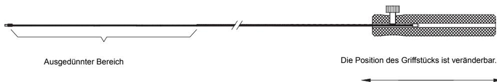
**Abbildung 5** Zuführungskabel
